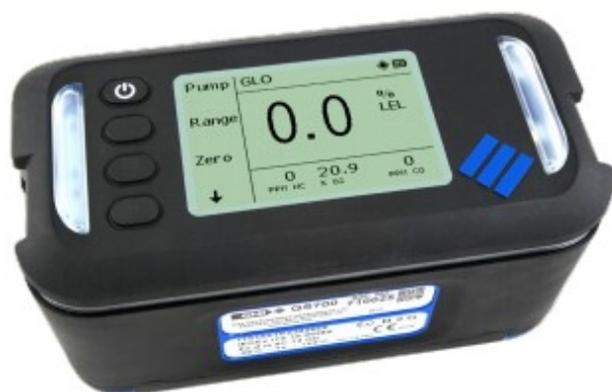
Équipé de la toute dernière technologie infrarouge de détection de gaz, le Gasurveyor 700 (GS700) est un appareil robuste et fiable, offrant de nombreuses options de configuration. Grâce à ses performances élevées et à son interface conviviale, il convient parfaitement à toutes les applications de distribution de gaz.
