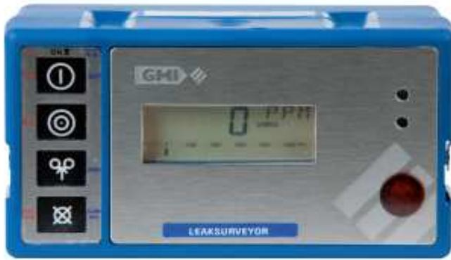
Le **LEAKSURVEYOR** est un appareil de recherche de fuites de gaz à technologie « semi-conducteur » combinant temps de réponse très rapide et sensibilité. Son domaine d'application s'étend du réseaux gaz à l'assainissement par le biais de gaz traceurs.
