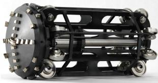
Les têtes de fraise sont équipées de dents de carbure fusées dans des logements en acier inox et d'une dent diamant centrale avec un dispositif de refroidissement et des morceaux de diamant. L'anneau de turbine à ailettes augmente non seulement le couple, mais permet aussi de rester dans l'axe lorsqu'on avance.
