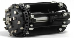
Ces fraises innovantes sont construites en acier inox trempé et offrent une grande efficacité de rotation et de poussée. La pièce d'entraînement elle-même est en acier inox trempé comprenant un arbre d'entraînement et deux roulements doublement scellés. Cela élimine le recours à un moteur hydraulique et ainsi le besoin de lubrifier, ce qui assure des années d'utilisation avec un entretien réduit.
