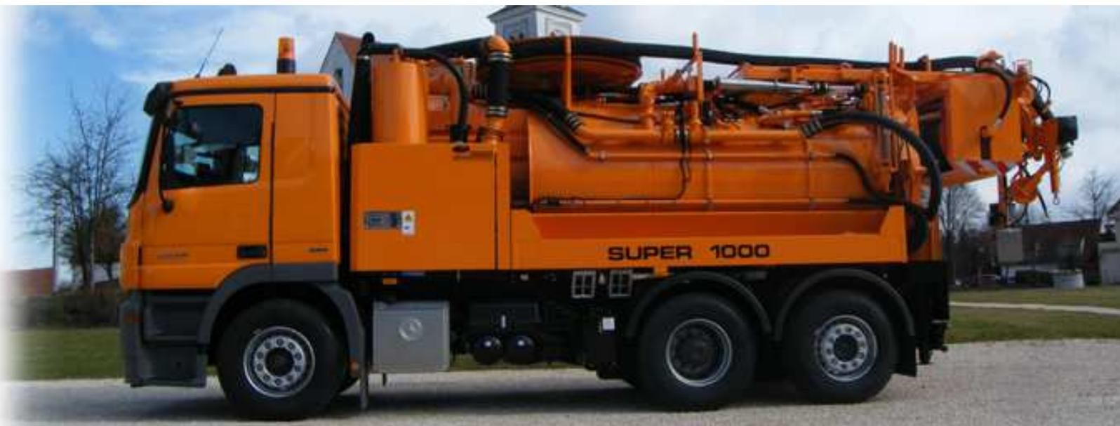
Réservoir à boues: jusqu'à 8000 litres
