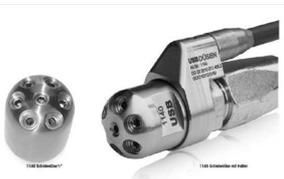
**Buse de poussée** sans jets arrière. Pour dissoudre les obstructions domestiques ou pour transporter de matériaux dissous vers l'avant. 6 x 15° + 1 x centré.
