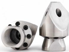
La buse **Quattro** est particulièrement performante dans les situations difficiles, en particulier lorsque des pressions extérieures ont déformé la conduite ou en cas de blocage complet. Les modèles à jets avant et à pointe permettent de percer les blocages et d'en transporter les débris, les modèles sans pointe mais à angle vif permettent un nettoyage rapide plus général.
