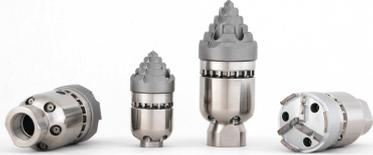
La buse **PIPE WOLF** est un outil de coupe unique. Une tête en acier inox trempé est entraînée par une turbine et tourne à une vitesse allant de 6000 à 12000 tours/min. Dans des situations extrêmes, c'est un outil hautement efficace. La buse Pipe Wolf réussit là où les outils hydro dynamiques standards échouent, augmentant ainsi la productivité et réduisant les coûts opérationnels.
