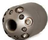
**Radial-Clean:** nettoyage radiale pour une purification complète sans traces jusqu'à 500 mm. Résultat de nettoyage parfait avec une puissance de traction maximale - Nettoyage de plus grande distance en moins de temps avec un résultat de nettoyage sans traces. **Radial-Clean** est la buse 3D parfaite avant l'inspection par caméra!
