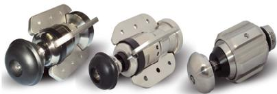
La buse **PRIMUS** est une buse de nettoyage de réseaux d'assainissement à vitesse de rotation contrôlée. La buse est entraînée par l'eau issue d'un tuyau sous pression. Le contrôle de la vitesse de rotation est réalisé par l'angle d'incidence des jets en conjonction avec des disques d'embrayage internes en céramique de haute performance.
