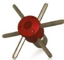
La buse **Spin-Jet** est conçue pour le curage des puits d'accès et des regards d'égouts avant réhabilitation. L'Alphajet est mue par l'eau fournie par le tuyau sous pression du camion hydrocureur. Quatre buses motrices entraînent la rotation à 360° dans un plan horizontal, deux buses oscillantes dans un plan vertical complètent le nettoyage.
