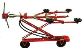
**Eibow:** Appareil de nettoyage spécialement conçu pour les profils ovoïdes. Applicable pour profil ovoïde jusqu'à une hauteur de 2400 mm. Réglage en continu du traîneau sans outils. Nettoyage à travers la totalité de la section transversale 360° en un passage de rinçage. Facile à introduire dans des ouvertures de puits de 500 mm et immédiatement commencer avec le processus de nettoyage.
