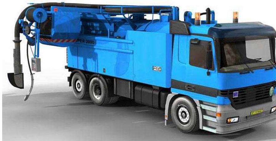
De ce fait, le tuyau d'aspiration et le tuyau haute pression peuvent être introduits ensemble dans la canalisation, le cas échéant par dessus des obstacles.
