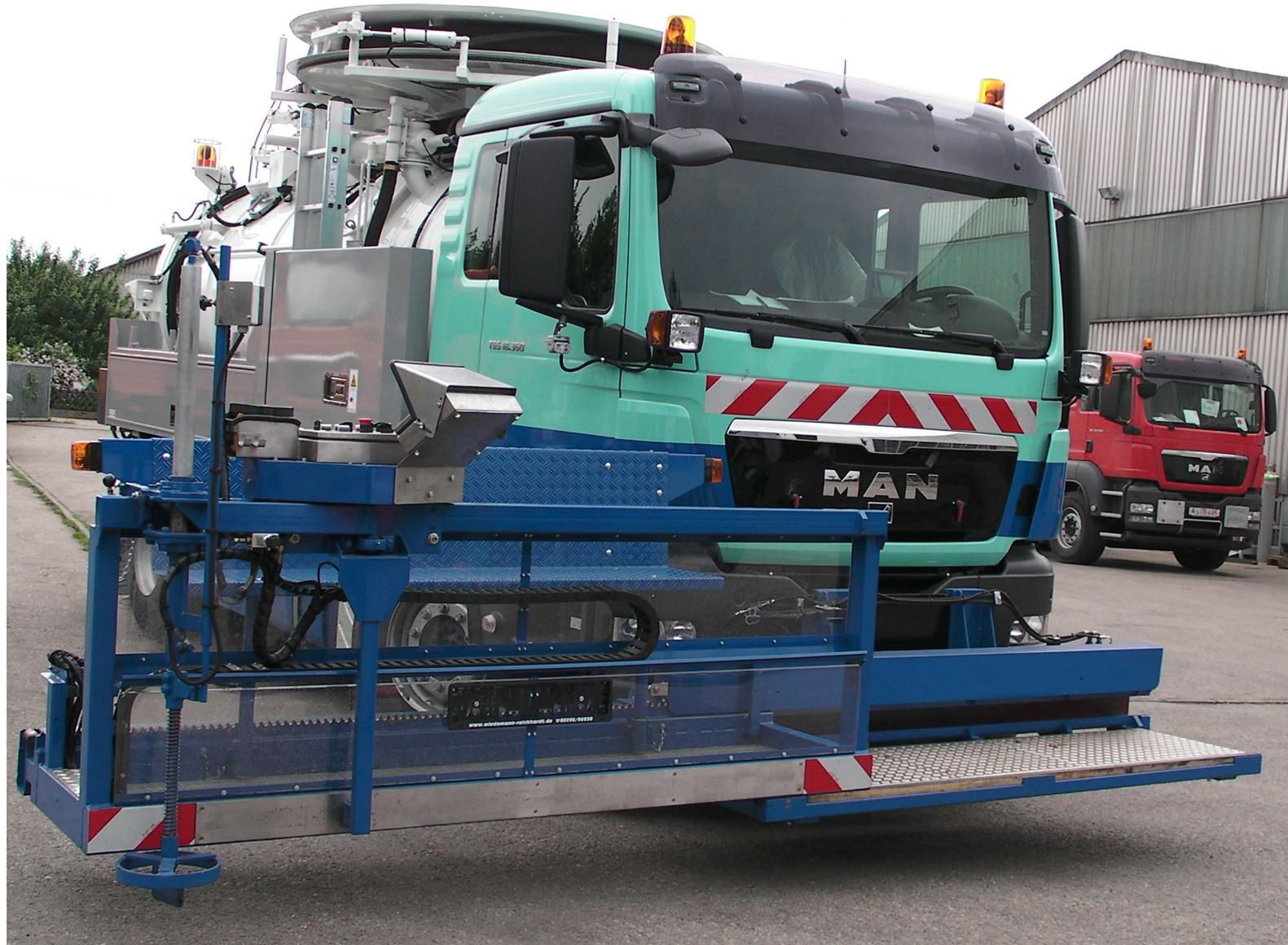
L'opérateur peut **depuis sa plate forme** faire avancer le porteur, le guider pour aller d'un avaloir à un autre et le stopper, déplacer sa plateforme à gauche et à droite du porteur de 2 à 2,5 mètres, soulever le couvercle de l'avaloir, introduire le tuyau d'aspiration et nettoyer le regard avec le pistolet haute pression et refermer l'avaloir.
