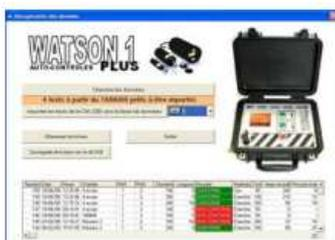
Nos pénétromètres à énergie constante sont destinés à la réception des canalisations selon la norme NF P94-063. Equipé de la fonction B et fourni avec le catalogue de cas du CR de Rouen. Ils peuvent également être utilisés en fonction C ou résistance de pointe en MPa. Différents modes de fonctionnement sont proposés en fonction de la spécificité de vos chantiers.
