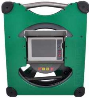
**MINIFLEX** - Caméra compacte intégrée en cassette. Diamètre d'inspection de 32 à 100mm. Longueur de fibre 15m x 5.8mm (30m en option). Enregistrement photos et vidéos sur carte SD.
