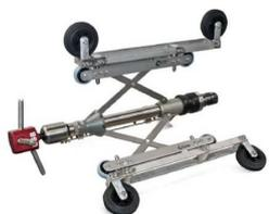
**Radiflex:** spécial pour le nettoyage des profils circulaires de 500 mm à 2'500 mm. Nettoyage complet 360° en un seul passage. Peut être introduit dans des ouvertures de puits de 500 mm et est prêt à l'emploi sans montage. 100% apte à l'eau recyclée. Extrêmement simple à utiliser.
